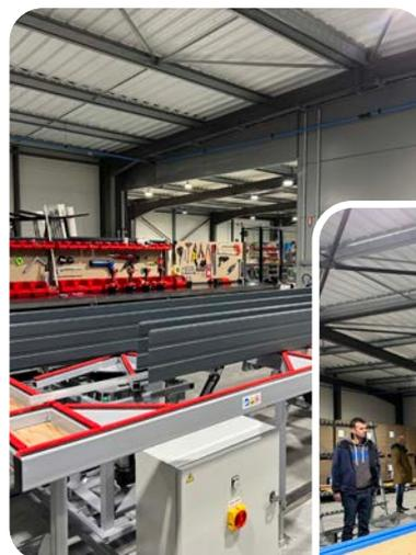
Poste d'assemblage avec table ergonomique
